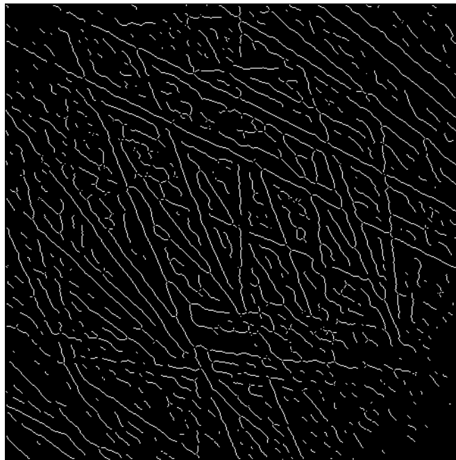
Rys. 5.2 Obraz binarny po operacji ścieniania
