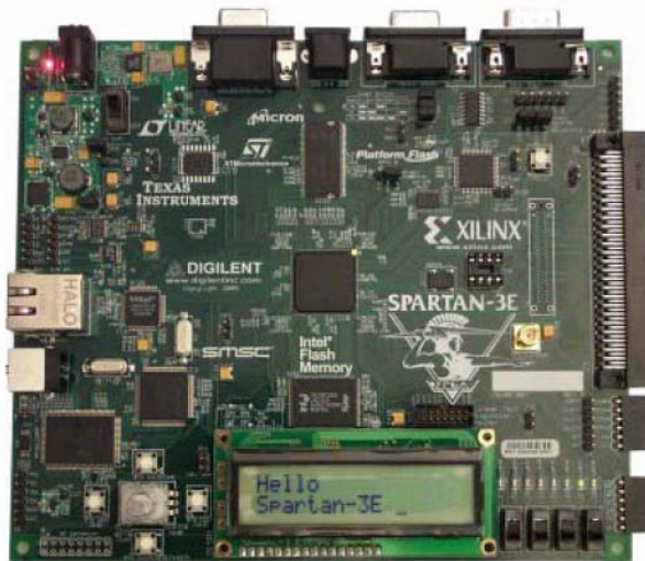
Figure 5.15. Photo de la carte de prototypage FPGA (a)
