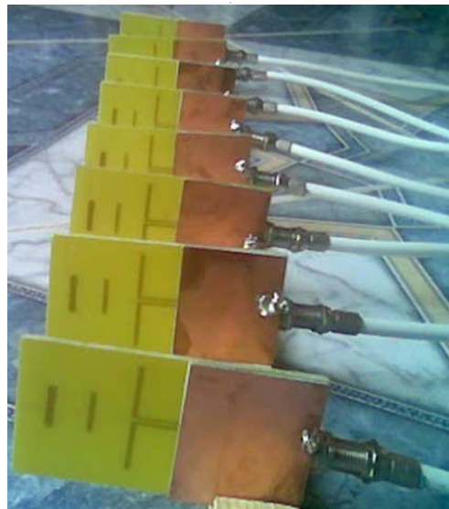
Figure 4.16. Réseau linéaire composé de 8 antennes quasi-Yagi (plan 2)
